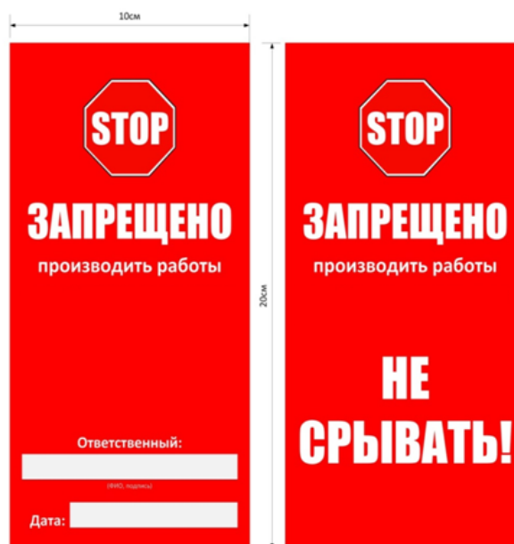
Рисунок 2 – Бирка, запрещающая использование средств подмащивания
