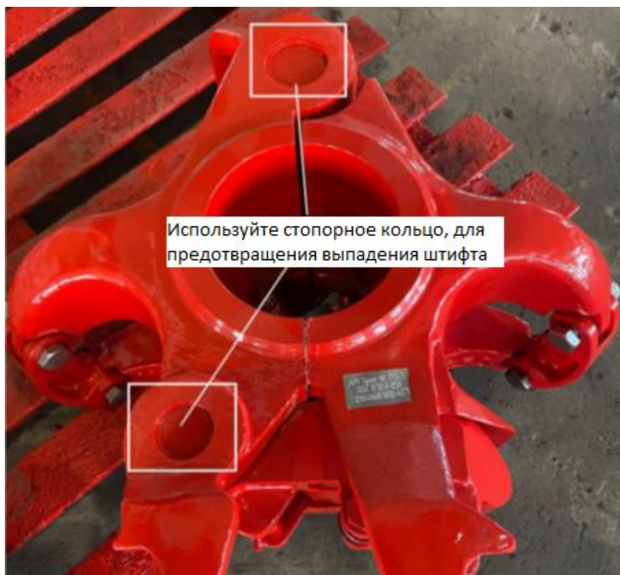
Рисунок 8 – Страховка штифта элеваторов серий SLX и DDZ
