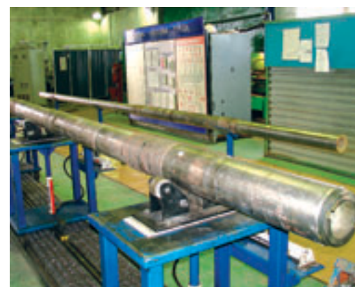
Приставка гамма-каротажа и резистивиметрии к телесистеме Sperry Sun.
