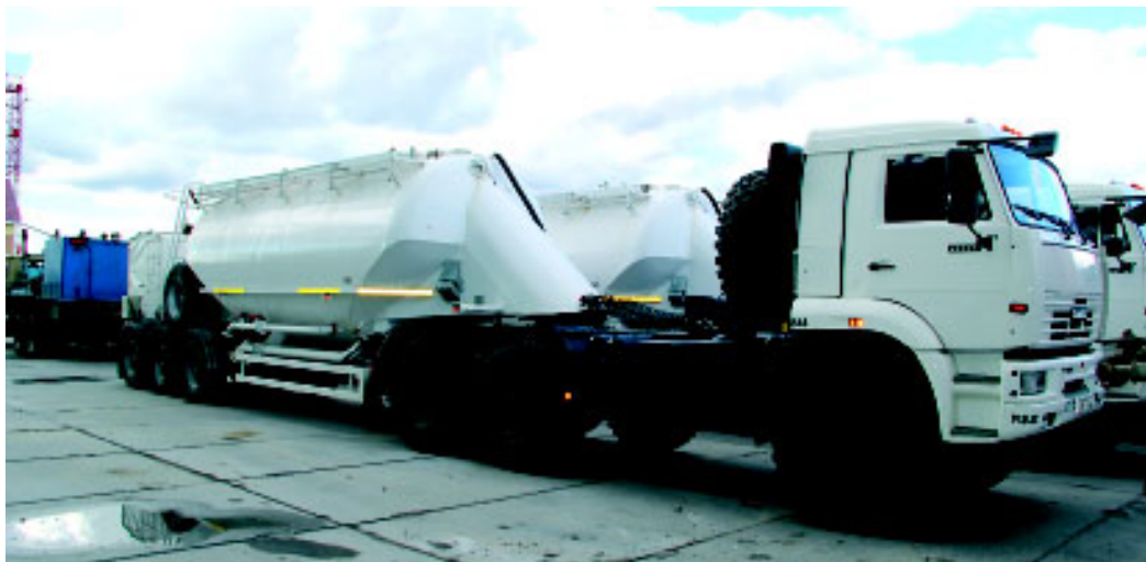
Мобильный склад берет на борт до 25 тонн цемента (фото А. Коновалова).
